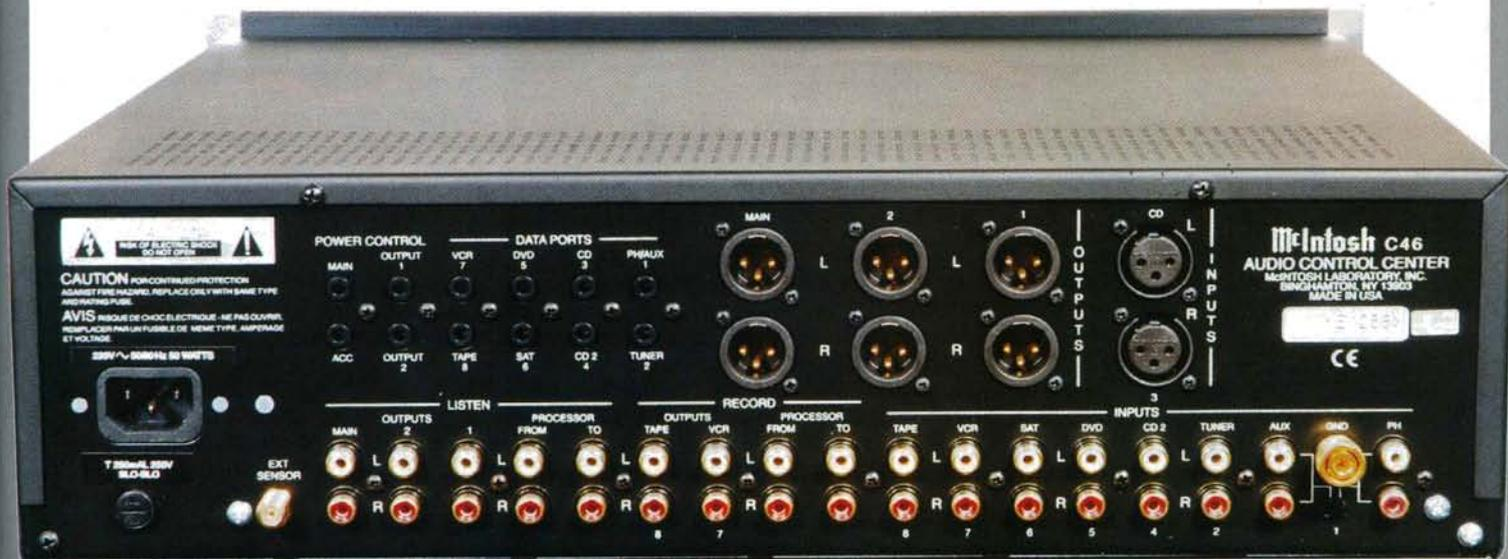
Il pannello posteriore dove si trovano le molteplici connessioni di ingresso/uscita sia bilanciate che sbilanciate, la vaschetta che ospita l'alimentazione, le varie connessioni dati e controllo accensione per gli altri elementi McIntosh eventualmente presenti nell'impianto.
